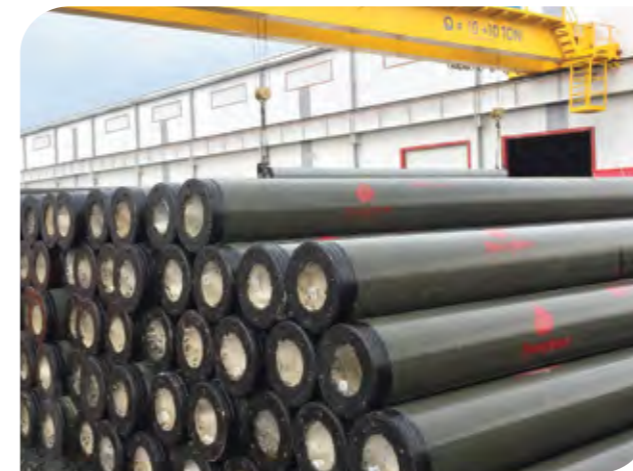
Sản phẩm cọc bê tông ly tâm dự ứng lực Đồng Tâm được sản xuất tại Bến Lức, tỉnh Long An
